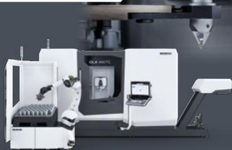
Kürzeste Rüstzeiten dank automatischem Werkzeugwechsel mit bis zu 60 Werkzeugen. Mit Robo2Go – perfekt automatisiert!
