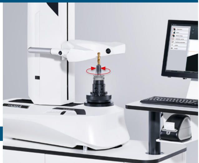
Automatisches Scharfstellen der Schneide Automatic focus on the cutting edge
