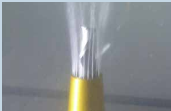
Manguito de tope con boquillas – Refrigeración ineficiente, el refrigerante no alcanza el filo Manga deslizante com bicos – Refrigeração insuficiente, o refrigerante não chega a la aresta de corte
